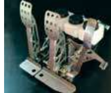
o: die mehrfach verstellbare Pedalerie, r: aramidwabenverstärkte Karosserieteile
