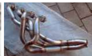
o: Ein beinahe fertiggestelltes Abgasrohrbündel u: Nach dem Klarlackieren, Front & Heck im Hintergrund warten auf den roten Basislack
